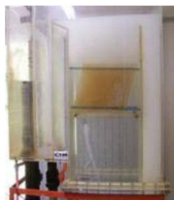
Figura 2. Detalhe de célula FADAT operando com microbolhas gerada com bomba multifásica
