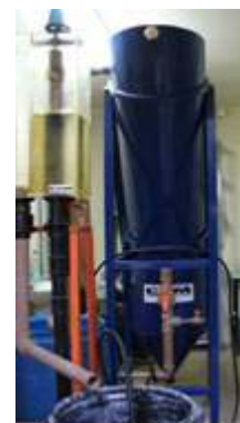
Figura 4. Detalhe do Sedimentador de lamelas empregado
